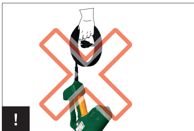
Ne soulevez pas et ne transportez pas l'appareil par le câble de raccordement.
